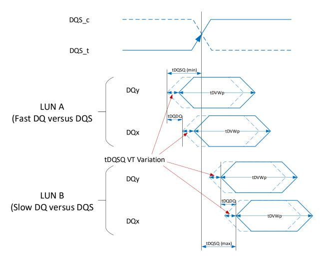
Figure 4-46 Data output valid window timing for >1200MT/s – tDQSQ, tDQDQ, tDVWp parameter
