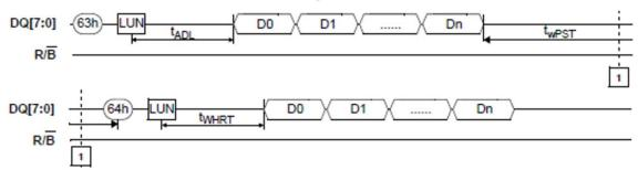
Figure 128 Write DQ Training (Tx side)
