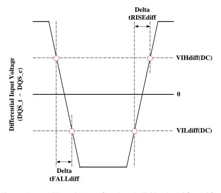
Figure 45 Differential Input Slew Rate Definition for DQS\_t, DQS\_c
