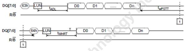
Figure 32 — Write DQ Training (Tx side)
